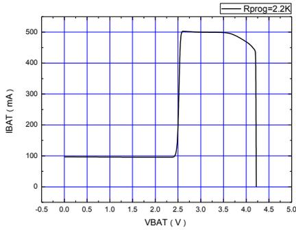
测试条件:  $V_{in}=5V$ ,  $R_{prog}=2.2K$
