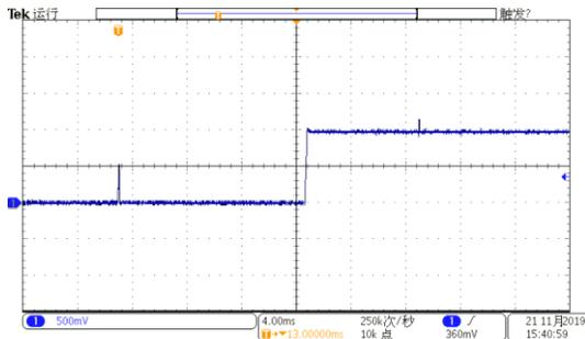
测试条件:  $V_{IN}=5V$ ,  $V_{BAT}=3.6V$ ,  $R_{prog}=2K$
