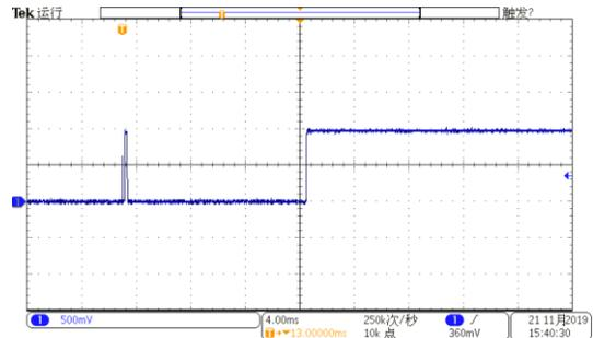
测试条件:  $V_{IN}=5V$ ,  $V_{BAT}=3.6V$ ,  $R_{prog}=10K$
