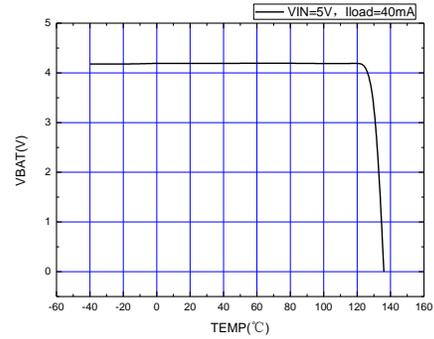
测试条件:  $V_{in}=5V$ ,  $R_{prog}=2.2K$ ,  $I_L=40mA$
