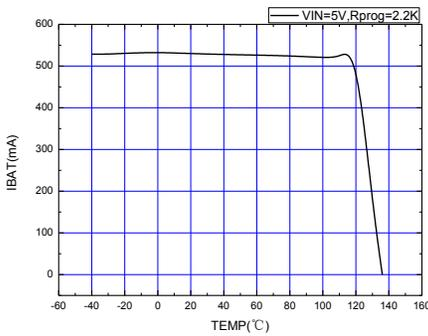
测试条件:  $V_{in}=5V$ ,  $R_{prog}=2.2K$ ,  $V_{BAT}=3.6V$
